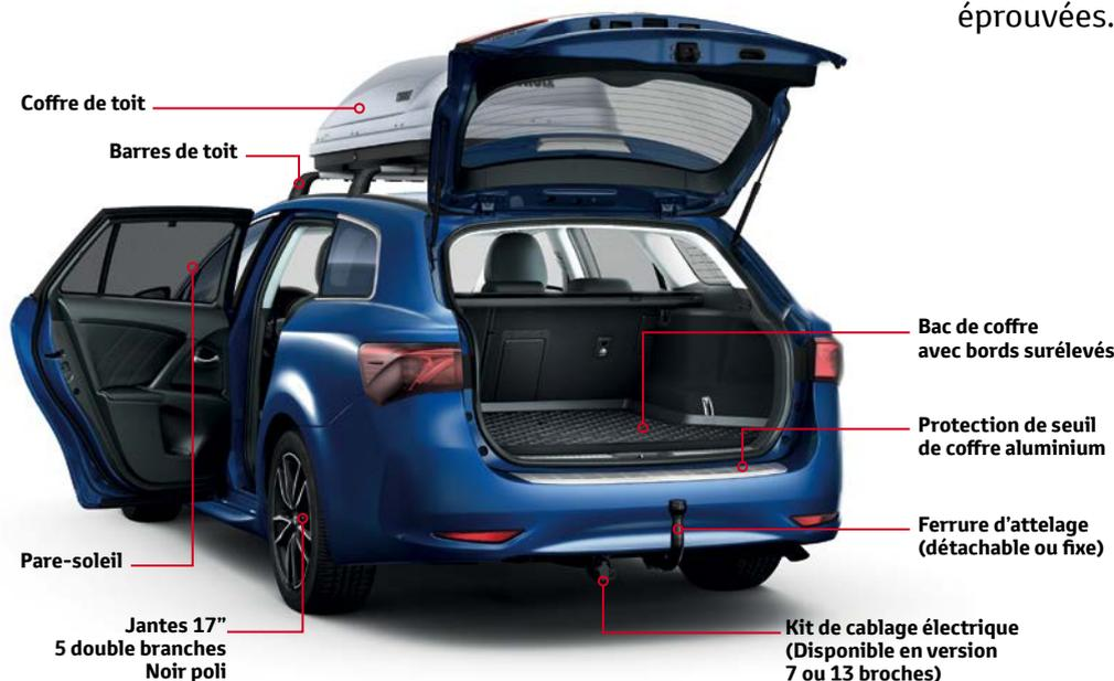
Un supplément de bagages, votre équipement sportif, des vacances aux sports d'hiver... Toyota met à votre disposition une gamme d'accessoires de portage conçus pour s'adapter parfaitement aux barres de toit transversales aluminium d'origine Toyota.
