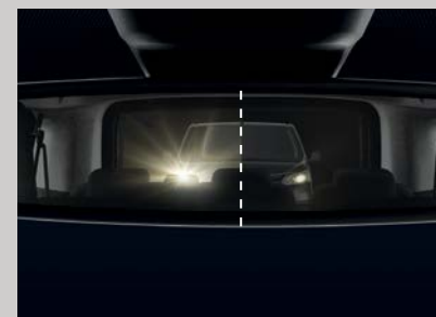
Rétroviseur intérieur anti-éblouissement (partie droite) vs normal.
